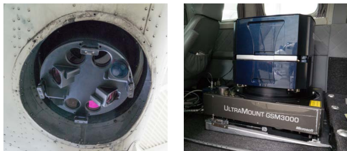
Abb. 1: UltraCam Osprey Mark 2 Sensorkopf von unten (links), Kamerasystem und Kreiselstabilisierung innerhalb des Flugzeugs (rechts).
